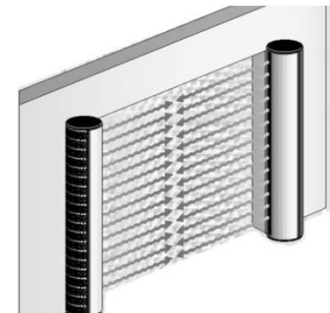
Instalacja po obu stronach drzwi
