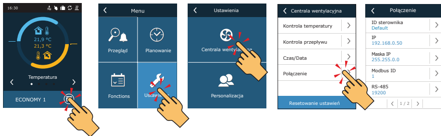
Rys. 48. Adres IP można zobaczyć i zmienić na panelu sterowniczym
