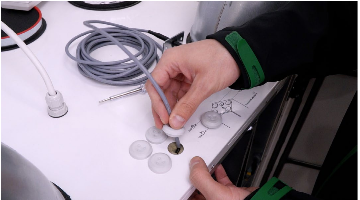
Przeprowadź przewody czujnika B1 przez przelotkę górną i gniazdo w obudowie.
