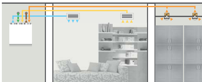
Z oddzielnie podłączanymi dodatkowymi wyciągami powietrza Jeśli nie stosuje się okapu kuchennego, do urządzenia można podłączyć także dodatkowy wyciąg powietrza z łazienki, pralni lub innych pomieszczeń.
