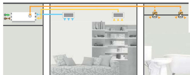
Z dodatkowo podłączonymi dyfuzorami wyciągowymi
