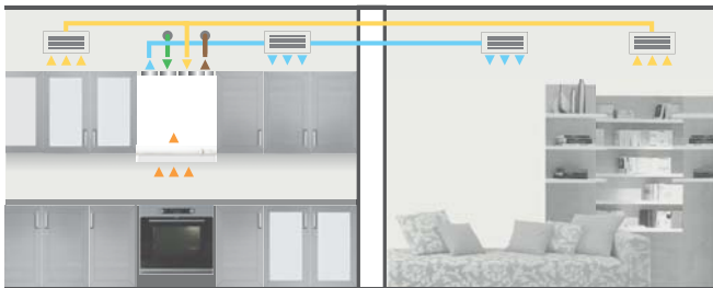
Z bezpośrednio zintegrowanym okapem kuchennym (tylko REGO 200V)
